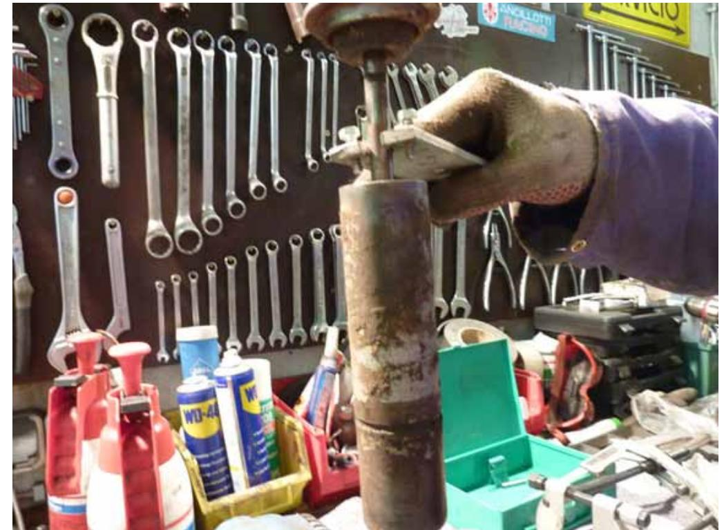
ABER VORSICHT: dabei keinesfalls den Stoßdämpfer nur mit dem unteren Auge im Schraubstock fixieren – wie man sieht ist die Schweißverbindung dafür nicht stabil genug! Besser waagerecht in den Schraubstock und dabei die V-förmigen „Backenschoner“ einsetzen.
